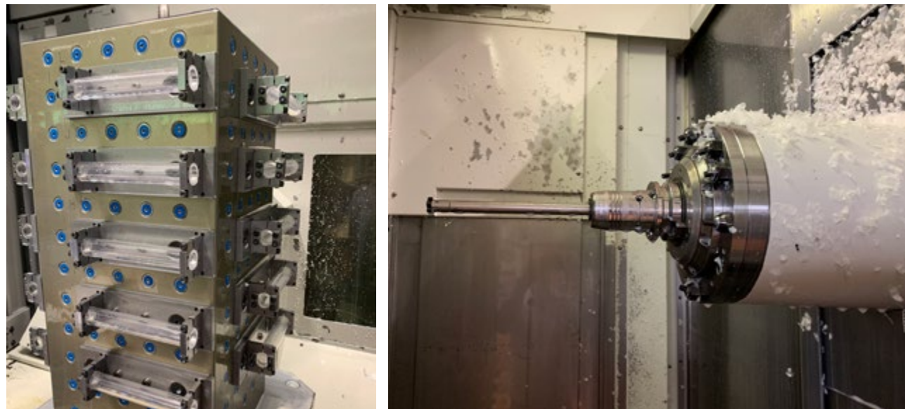
Pro Turm werden 20 Teile aufgespannt. Dies ergibt eine Zeitersparung von 189 Minuten pro Turm!
