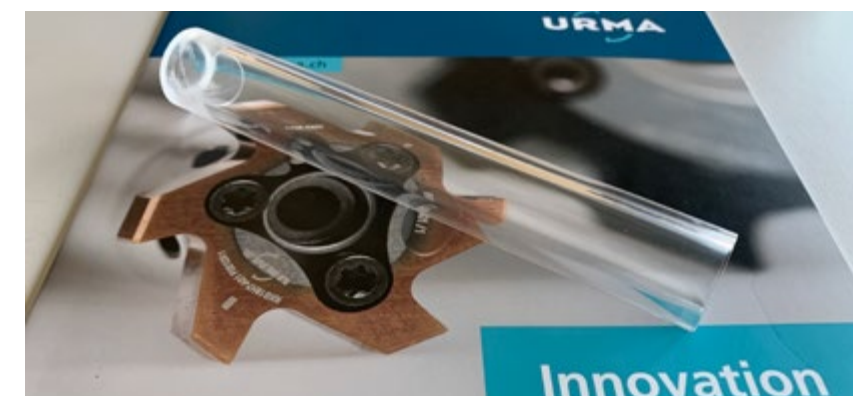
Fertig geriebenes Bauteil - Ra 0.12 / Rz 1.05
